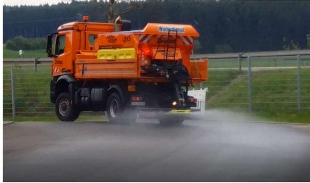
Bild: Beispiel eines Streugerätes, das reine Lösung über den Streuteller ausbringt
